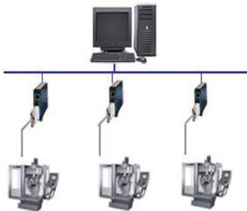
Die Maschinen wurden mit je einem COM Server und Ethernet Kabel verbunden
